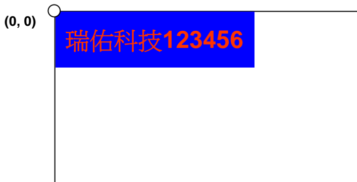
圖 6-7: 透過外部字庫在圖層 1 寫入 GB12345 字串
