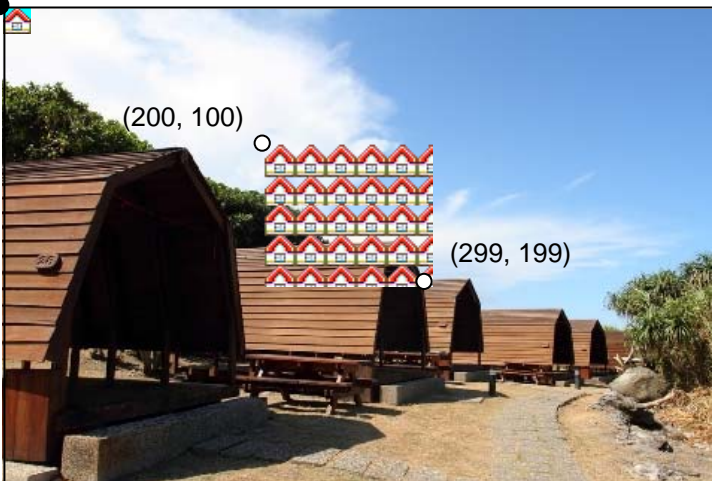
圖 4-16: 執行 “pattern fill with chroma key(w/o ROP)” 功能，圖案樣版的來源是從圖層 1 的(0, 0) 到 (15, 15)，而目的地的範圍是從圖層 1 的(200,100) to (299,199)。
