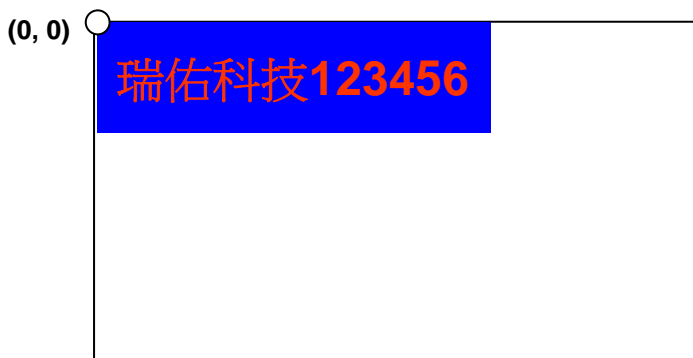
圖 6-6: 透過外部字庫在圖層 1 寫入 GB2312 字串
