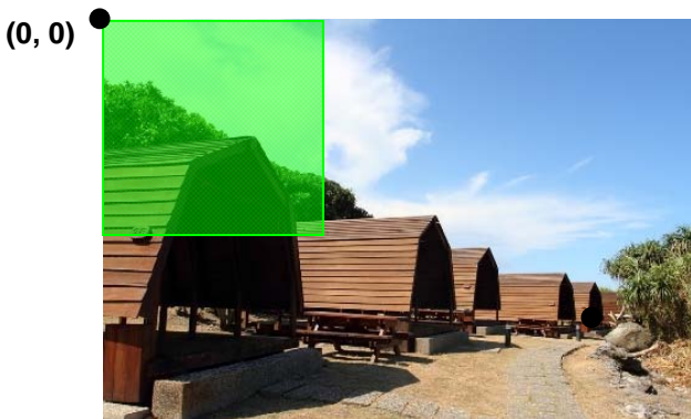
圖 4-51: 來源 0 從圖層 1 的(0,0)到(199,199),來源 1 從圖層 2(0,0)到(199,199),在 alpha 值為 16 下,使用 alpha blending 並且顯示在目的地,圖層 1 的[(0,0)到(199,199)]。
